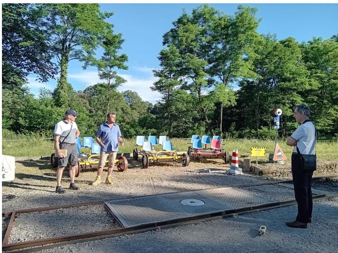
Pour manœuvrer les pédalos, M. Prat a également élaboré un pont tournant pneumatique. Le vélo-rail dispose de deux voitures capables de rouler aussi bien sur la route que sur la voie, pratique pour intervenir rapidement sur la ligne.
